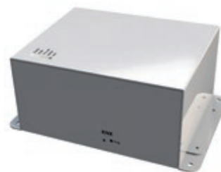
TO-RC-KNX-1i (Sběrnice ovladače A/B) TO-AC-KNX-16 (Sběrnice TCC-Link) TO-AC-KNX-64 (Sběrnice TCC-Link) Různé rozhraní KNX pro všechny jednotky RAV, ovládané pomocí sběrnice TCC Link nebo A/B.; pro napojení 1 jednotky přes sběrnici A/B a pak pro 16, resp. až pro 64 vnitřních jednotek přes TCC Link (16/64, svorky U1/U2); komunikace pomocí KNX protokolu.
