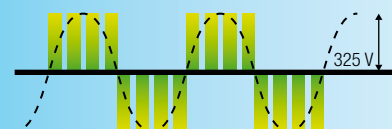
Různá frekvence při konstantním napětí 325 V.
